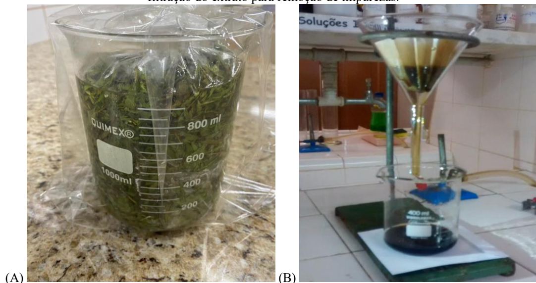
Figura 1 - Processo de coleta e extração da resina de Protium icariba . (A) Resina coletada no béquer; (B) Processo de filtração do extrato para remoção de impurezas.
