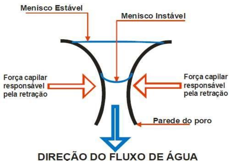
Figura 2: Forças capilares na retração. CORTEZ (1999) apud LEAL (2003).
