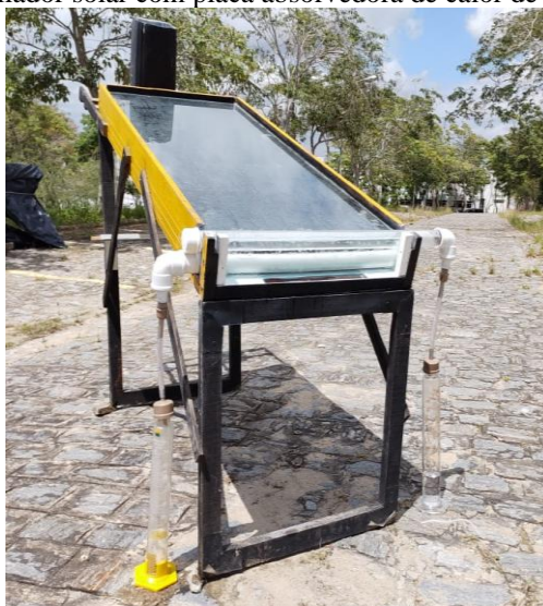
Figura 1. Destilador solar com placa absorvedora de calor de formato ondular
