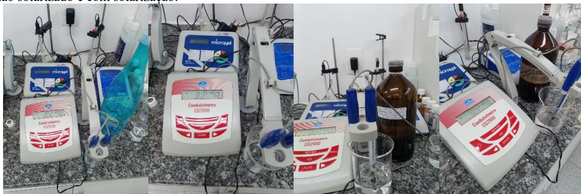
Figura 2 - Procedimento experimental da medição da condutividade elétrica da solução de água mineral e destilada, do floral não solarizado e com solarização.
