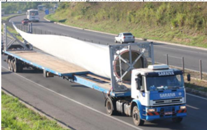
Figura 1 – Transporte rodoviário de pá de aerogerador rumo ao Parque Eólico de Brotas de Macaúbas (BA)
