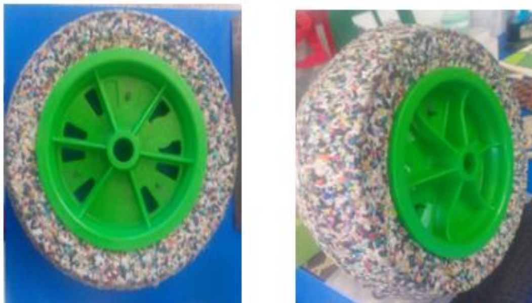
Figura 4: Pneu maciço feito com reaproveitamento de borracha de chinelos.
