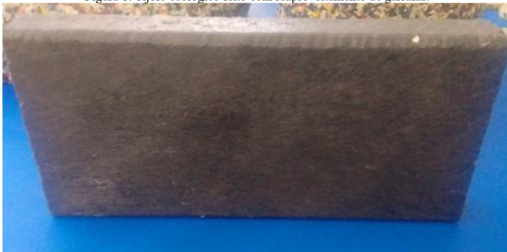
Figura 6: Tijolo ecológico feito com reaproveitamento de garrafas.
