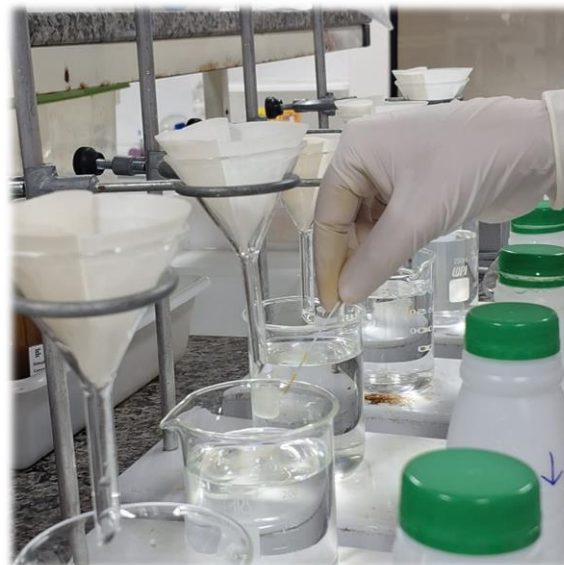
Figura 5 – Filtração e medição do pH da água
