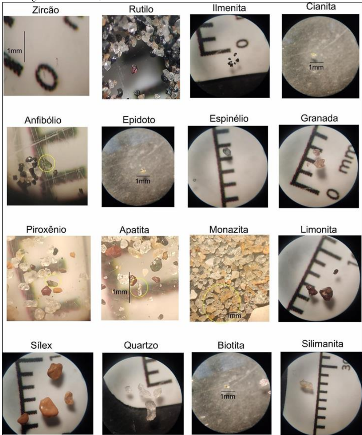
Figura 12: Foto dos minerais identificados por meio da lupa de aumento no laboratório de sedimentologia. Fonte: Autor, 2023.
