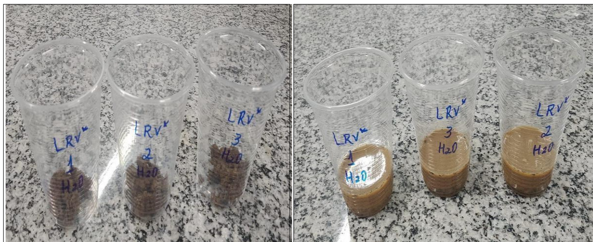
Imagem 4 - Preparação das amostras para análise de Ph com água destiada(H 2 O)
