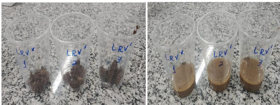
Imagem 3 - Preparação das amostras para análise de Ph na solução de \text{CaCl}_2
