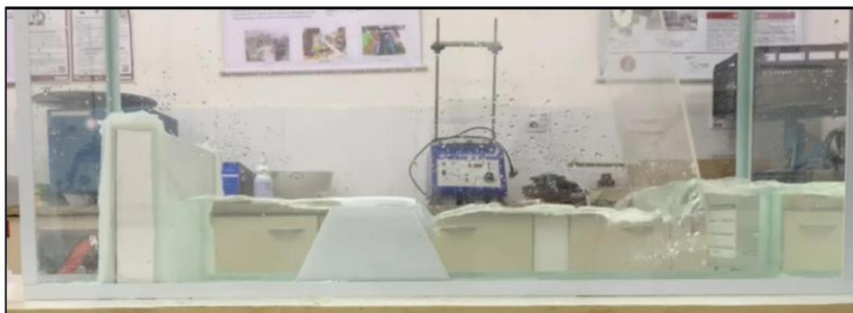
Foto: Experimento/Maquete Láb. Eng. Civil – UniVassouras/RJ, Talude Quebra Mar Submerso com empilhamento de energia quebrado
