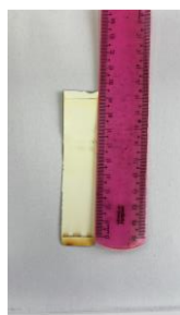
Figura 03: Amostras eluídas na placa cromatográfica revelados por iodo com valores de rf respectivos das amostras: extratos da folha pelo método estático com solvente etanol, folha pelo método ultrassom etanol e folha pelo método soxhlet etanol. Rf 1: 0,6 e Rf 2= 0,72 Rf 3= 0,74.
