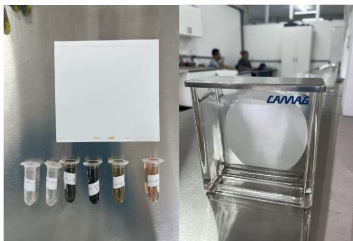
Figura 02: A: Amostras que foram aplicadas na placa de cromatografia em camada delgada B: Cuba cromatográfica preparada e saturada para a eluição.
