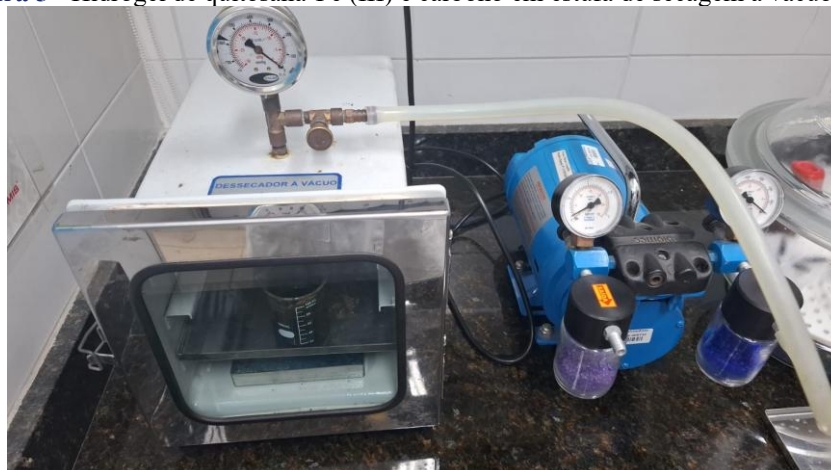
Figura 5 - Hidrogel de quitosana-Fe (III) e carbono em estufa de secagem a vácuo a 300
