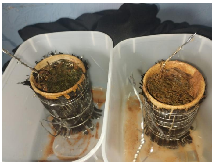
Figura 17 - BCMs da esquerda para direita, camada difusora de gás convencional, camada difusora de gás com catalizador de hidrogel Fe-N-C
