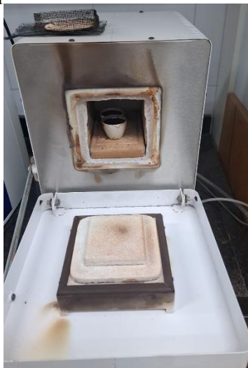
Figura 6 - Aquecimento da mistura forno de atmosfera inerte.
