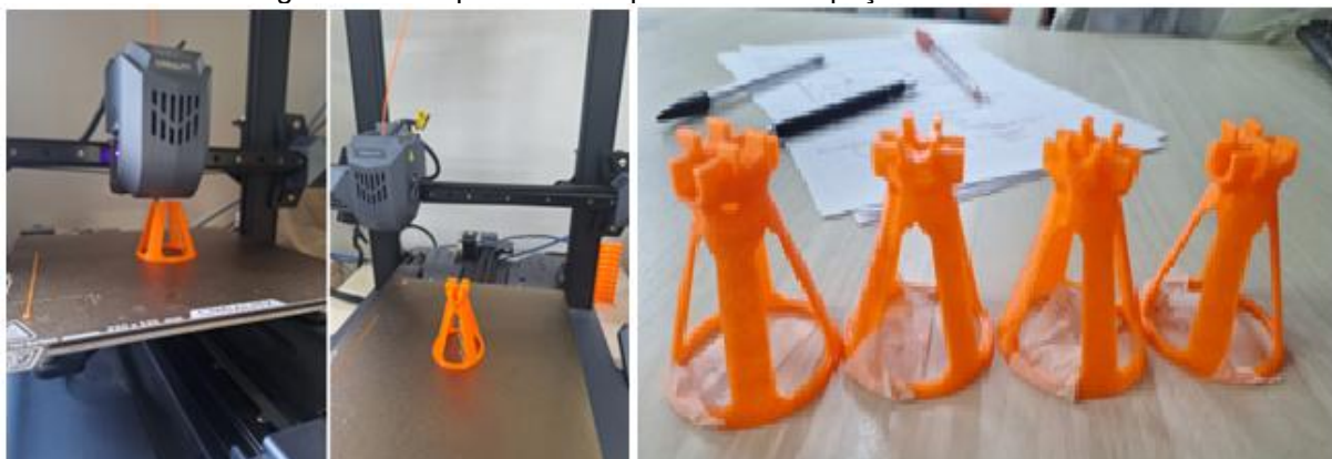
Figura 10 – Sequência de impressão dos espaçadores em PLA.
