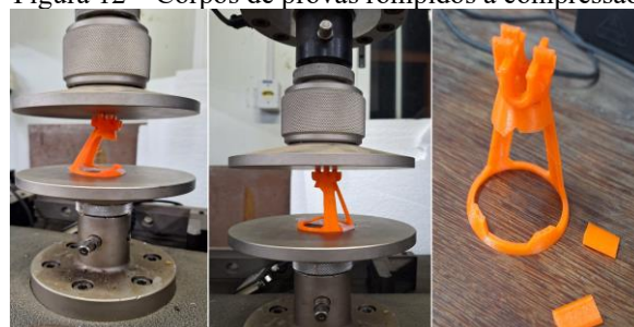
Figura 12 – Corpos de provas rompidos à compressão
