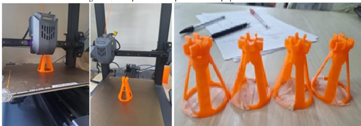
Figura 10 – Sequência de impressão dos espaçadores em PLA.
