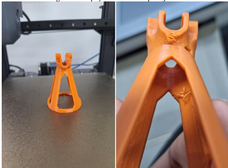
Figura 7 – Espaçador em ABS após ajustes.
