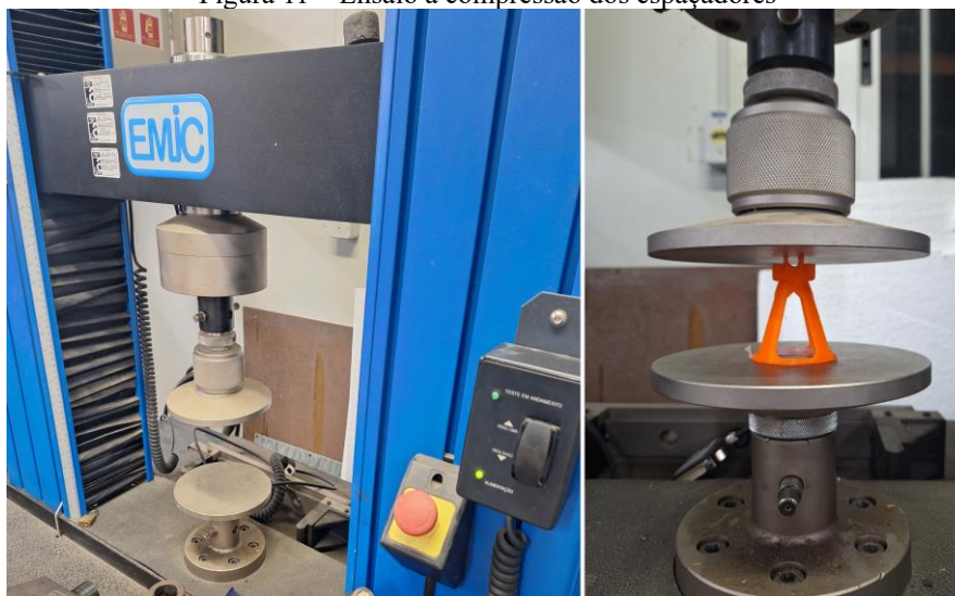
Figura 11 – Ensaio à compressão dos espaçadores
