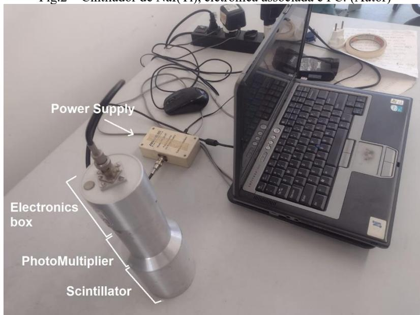
Na Figura 2 pode-se ver o conjunto eletrônico, fotomultiplicadora e cintilador de NaI(Tl) com maior nitidez, agora com a caixa de eletrônica em branco. Esse sistema de detecção de radiação gama integrado vai passar no mínimo, um mês fazendo medidas contínuas no laboratório Atmosrad do ITA.
