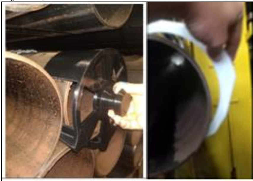
Figura 5 – a) Artefato 1 e Artefato 2 sendo utilizados nas medidas de diâmetro.
