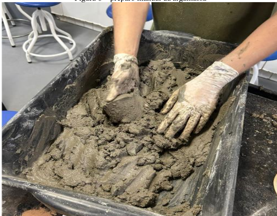
Figura 6 – preparo manual da argamassa
