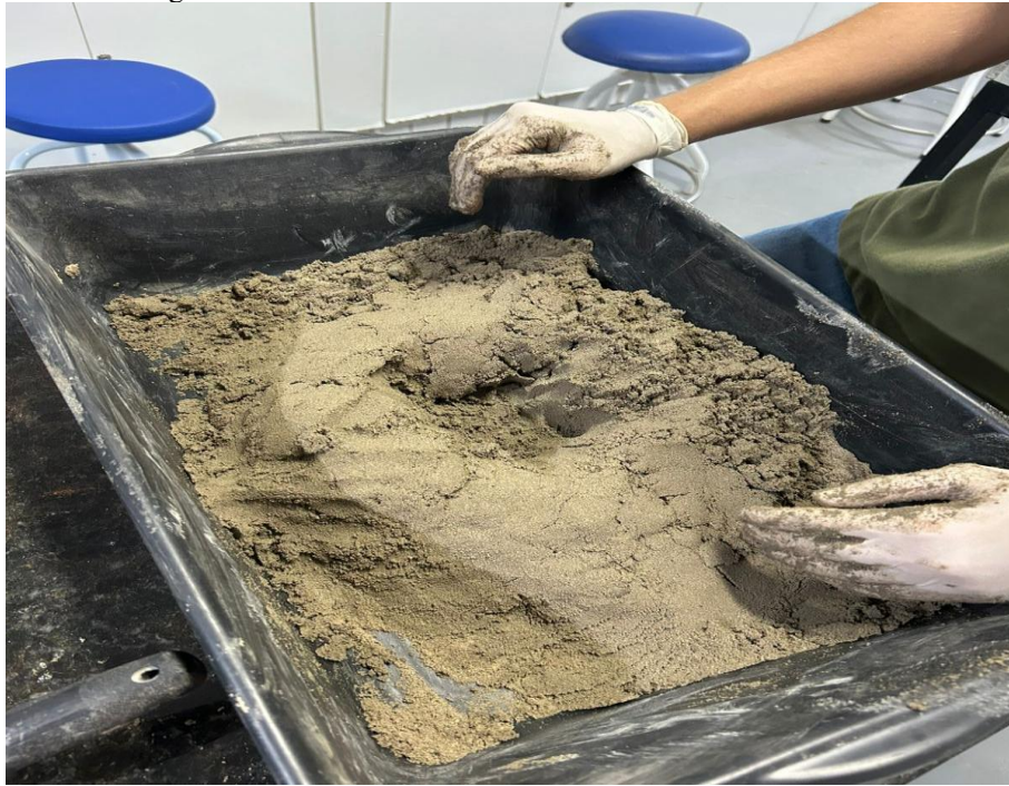
Figura 3 – Mistura a seco dos materiais no misturador manual
