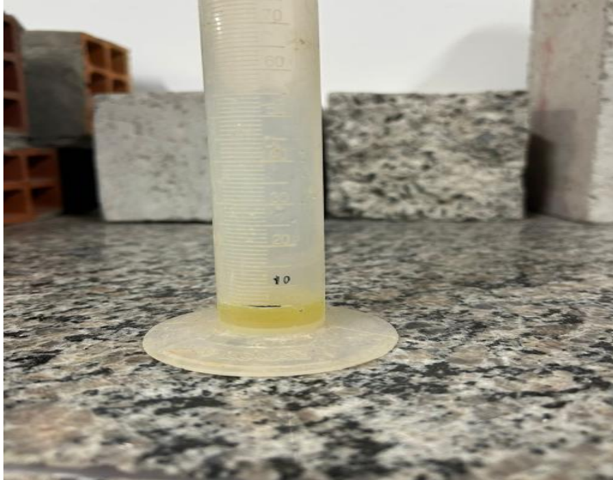
Figura 7 – Adição do aditivo ao primeiro traço de argamassa (5ml)
