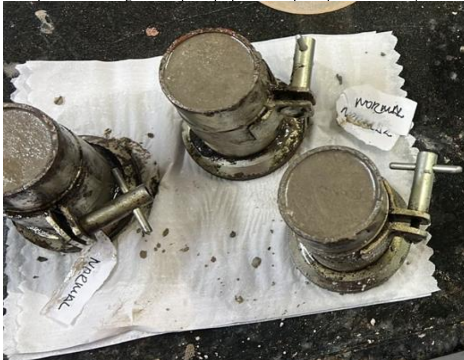
Figura 9 – Aspecto final da argamassa após o preparo no corpo de prova sem a adição do detergente
