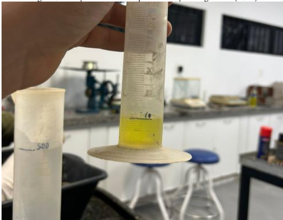
Figura 8 – Adição do aditivo ao primeiro traço de argamassa (10ml)
