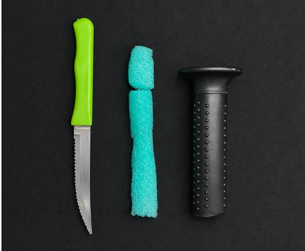
Figura 2. Flutuador recortado para ser inserido na manopla.
