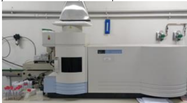
Figura 7: Espectrômetro de ICP-OES, modelo Optima 4300 da PerkinElmer utilizado.
