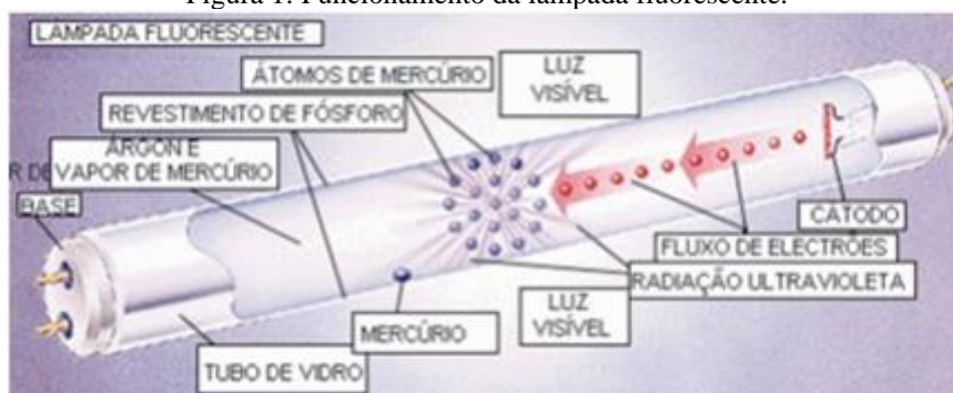
Figura 1: Funcionamento da lâmpada fluorescente.
