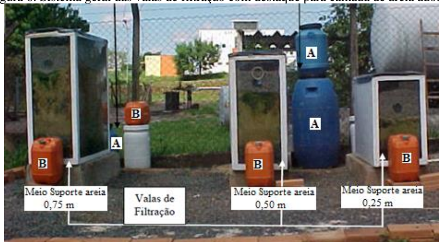
Figura 6: Sistema geral das valas de filtração com destaque para camada de areia adotada.
