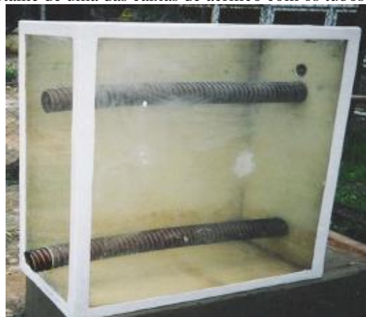
Figura 5: Detalhe de uma das caixas de acrílico com os tubos de drenagem.
