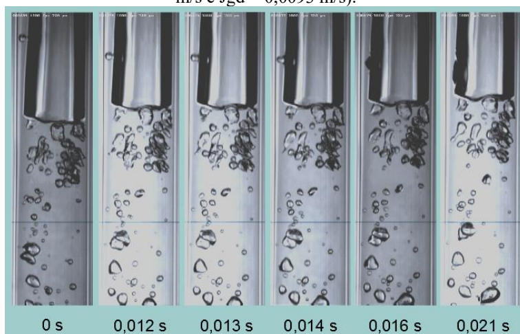
Figura 12 - Coalescência de uma bolha dispersa com a bolha de Taylor na região perto da cauda (1000 fps, Jl = 0,0644 m/s e Jgd = 0,0093 m/s).
